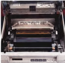
Il vano contenente il rullo di film plastico per il trasferimento dei colori. È visibile l'elemento termico che effettua tale operazione.
